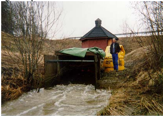
Figur 2. Mørdrebekken målerenne, Crump-overløp. Foto: Marianne Bechmann
